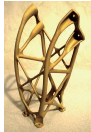
图7 SLM成形的航空航天铝合金结构 支架零件 Fig.7 Aerospace aluminum alloy structural support parts fabricated by SLM
